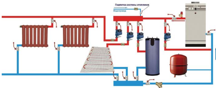
Рисунок 6. Схема подключения котла с общим коллектором.
