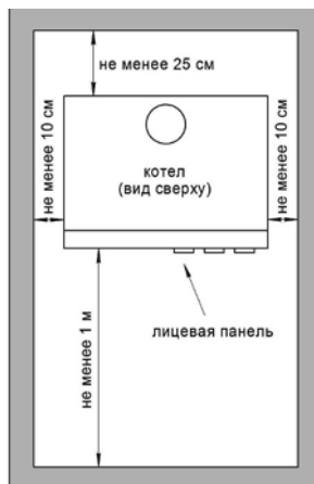
Рис. 5 – Схема установки котла
