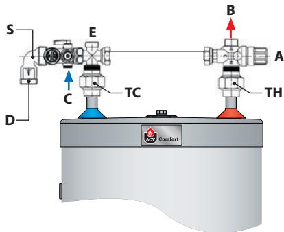
**ПОДКЛЮЧЕНИЕ К КОНТУРУ ОТОПЛЕНИЯ**
