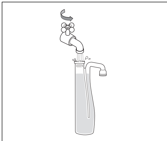
Рис. 16 Заполнение сифона водой
